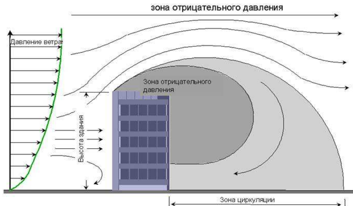
Рис. 2. Зона циркуляции ветра вокруг одного строения
